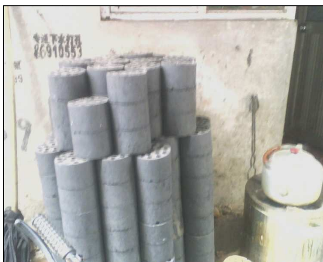
Figura 3.4 Bricchetti di carbone pressati ad uso domestico nelle vie di Pechino (foto: M. Mina, 2009)
