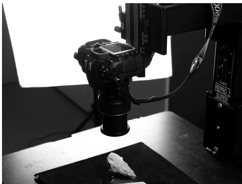
Figura 13- Strumentazione per la fotografia scientifica adottata, con particolare alla fonte di illuminazione in altro a sinistra
