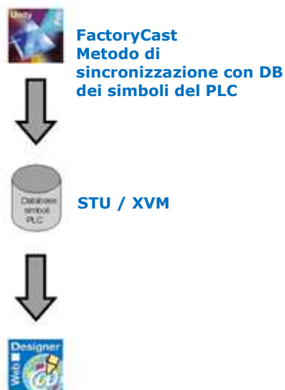
Figura 10: Sincronizzazione delle variabili in ambiente FactoryCast.
