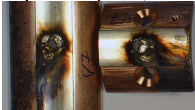
Fig.60: stato dei contatti in Ag/CdO dopo la sequenza di test
