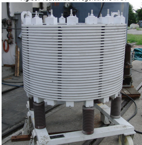
Fig.55: reattanza di regolazione in BT
