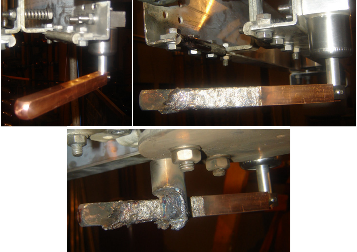
Fig.31: contatto mobile S2DA prima (sx) e dopo la prova (dx)
