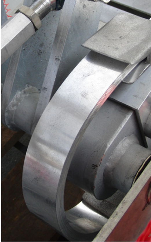
Fig.38: dispositivo di aggancio alla sbarra dei contatti mobili secondari
