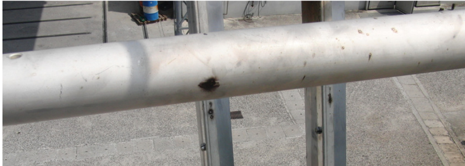
Fig.44: contatto principale fisso dopo la sequenza di prova (SX)
