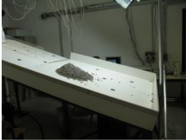
Figura 3.8: Nuova configurazione del materiale dopo aver variato la pendenza della canaletta.
