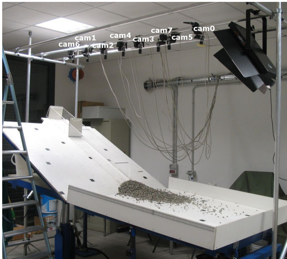
Figura 3.2: Apparato sperimentale per le prove di moto incanalato.
