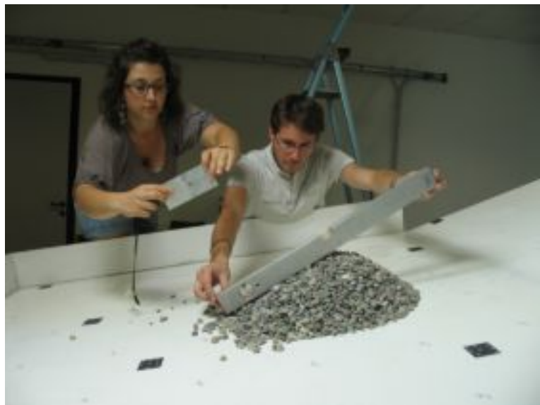
Figura 3.7: Determinazione manuale dell'angolo di riposo del materiale.
