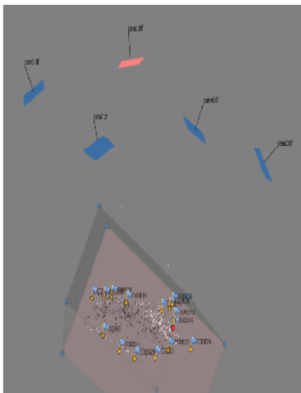
Figura 4.9: Generazione della nuvola di punti a seguito dell'allineamento delle camere.
