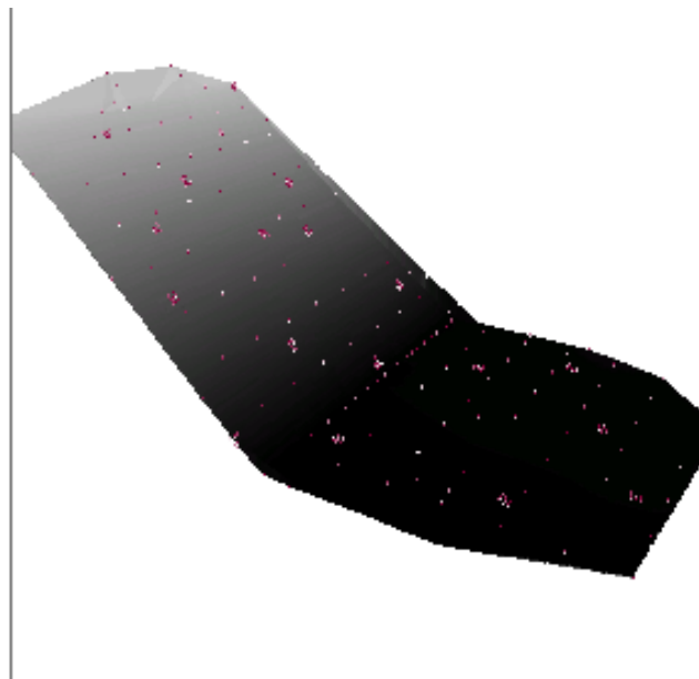
Figura 4.14: Canaletta in 3D elaborata in ambiente GIS attraverso l'uso di target retroflettenti e punti inseriti disegnati al fondo della canaletta.
