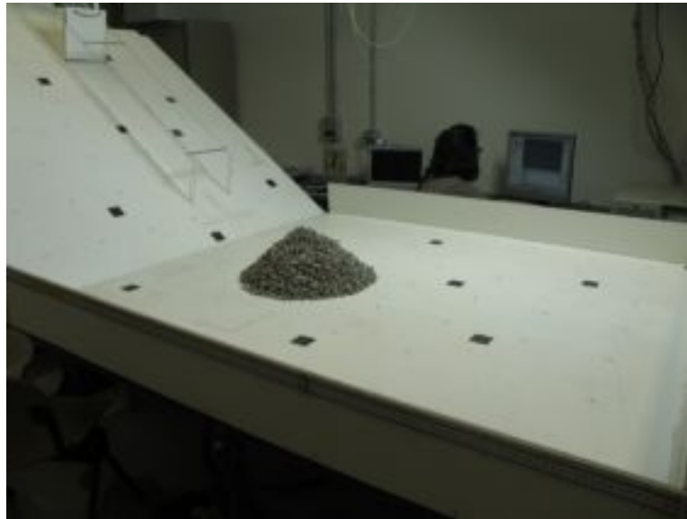
Figura 3.6: Accumulo del materiale sulla canaletta posta orizzontalmente.
