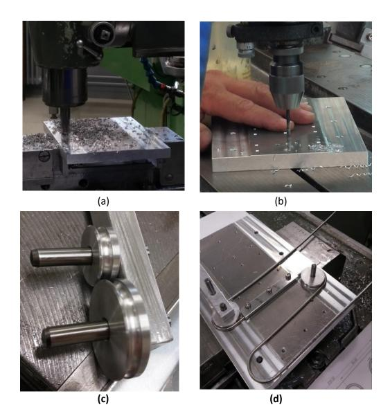
Fig. 41 (a), (b) support plate; (c) Jig; (d) pipe bending
