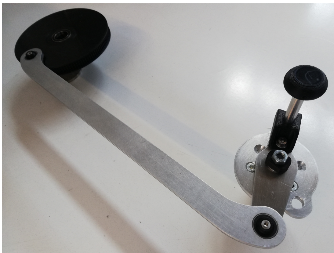
Figura 4.13: nuovi link del parallelogramma, e sistema di selezione della configurazione assemblati sul banco di lavoro.
