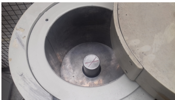
(a) Interno del basso-fondo con il rivelatore inserito.
