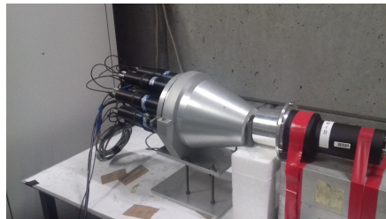
(c) Anti-Compton con BGO, LaBr e NaI.
