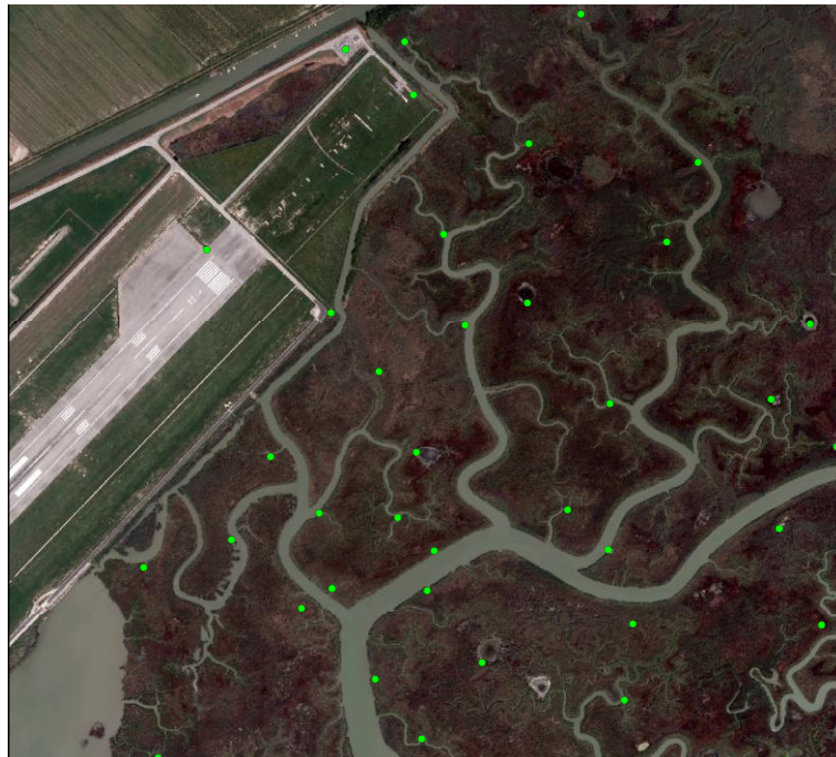
Fig. 3.3.1. Esempio di elementi puntuali (in verde) per la georeferenziazione degli aerofotogrammi della Palude di Pagliaga
