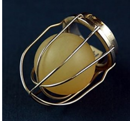
Figura 4.1: Valvola Harken con doppia gabbia in acciaio inossidabile e sfera in silicone.
