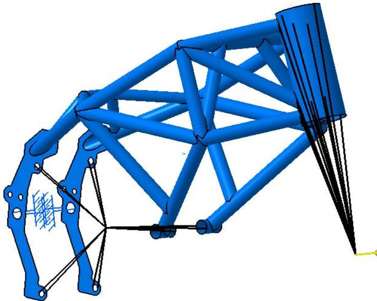
Figura 3.5: Simulazione rigidezza laterale
