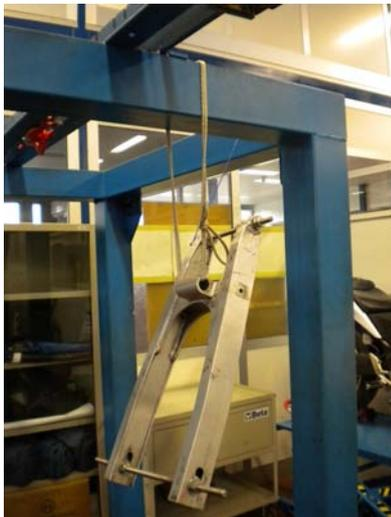
Figura 6.6: Misura delle frequenze naturali del forcellone
