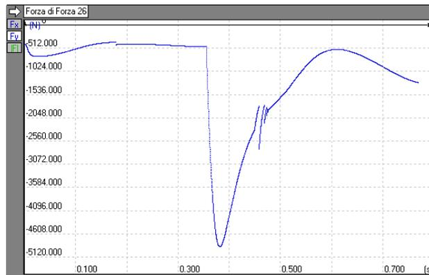
Figura 4.17: Forza agente sul perno ruota posteriore
