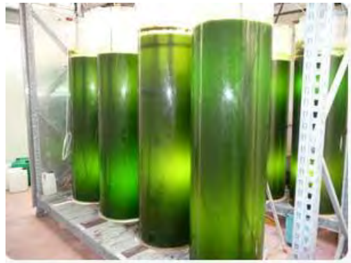
Figura 1.7. Fotobioreattore tubolare ( www.acquacoltura.jonica.it ).
