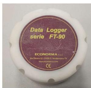
Figura 12 - Sensore per la misurazione della temperatura a terra, cartellino per identificare posizionamento sensore temperatura
