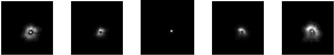
Figura 3.6: Serie di frame con defocus variabile. Da sinistra, PV pari a 1\lambda e 0.5\lambda intra-focale, poi solo \vec{v}_{\text{flat}} applicato, infine 0.5\lambda e 1\lambda extra-focale. Si assume \lambda = 630\text{nm} .
