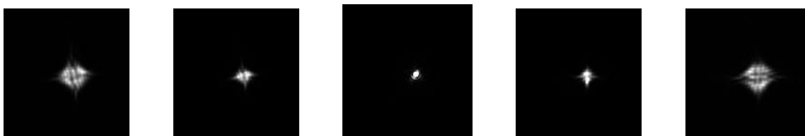
Figura 3.8: Serie di frame con astigmatismo variabile. Da sinistra, PV pari a 2\lambda , 1\lambda , 0\lambda , -1\lambda e -2\lambda . Si assume \lambda = 630\text{nm} .
