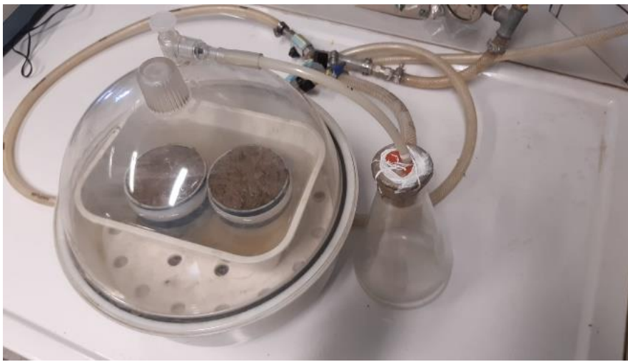
Figura 6: Campioni posti nell'essiccatore per rimuovere aria dai micropori
