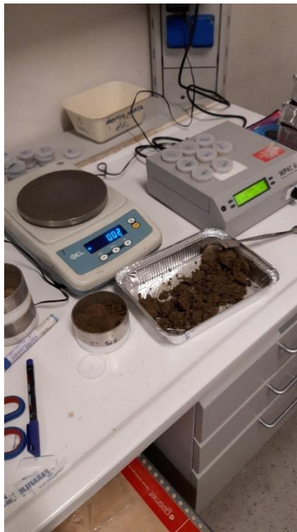
Figura 12: Campioni pesati e pronti per l'analisi tramite WP4C
