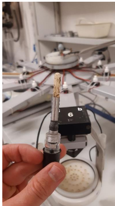
Figura 11: Tensiometro in primo piano, in secondo piano presenti supporto campioni e strumento WIND
