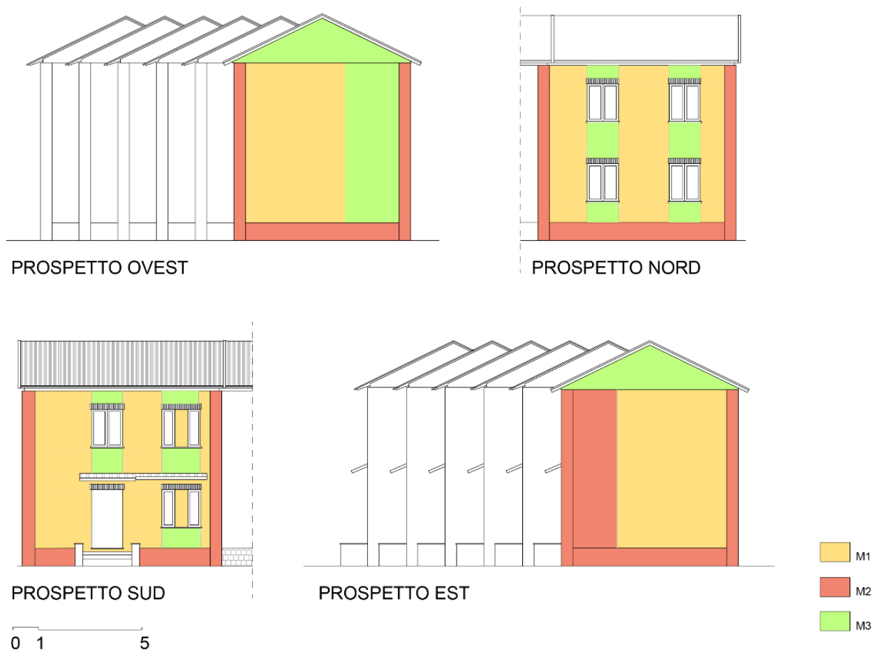
Figura 4.13: Individuazione tipologie di muratura nei prospetti (Valluzzi et al.,2020).
