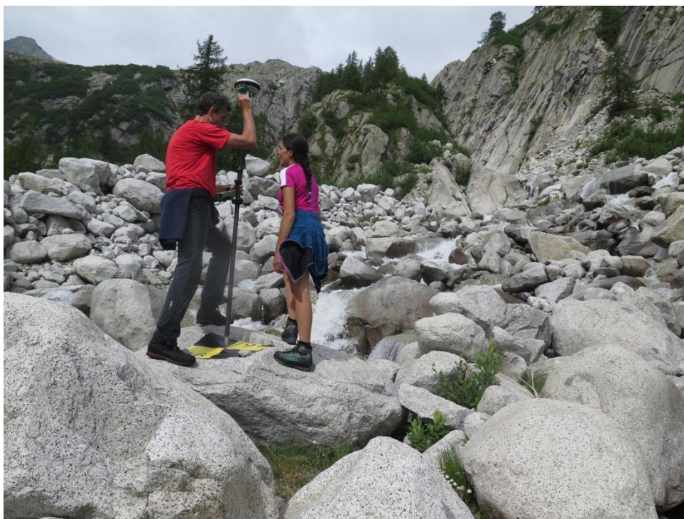
Figura 3.12. Misura delle coordinate geografiche tramite GPS differenziale in corrispondenza del target (foto N. Groff, 2022)
