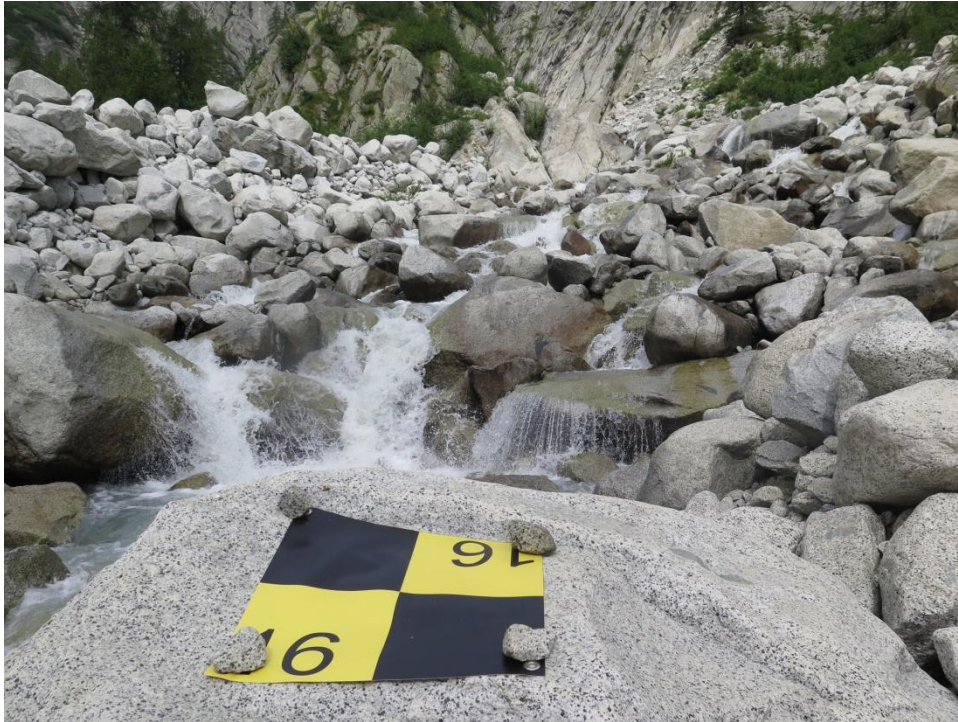
Figura 3.11. Posizionamento target sulla superficie del conoide (foto M.Groff, 2022)
