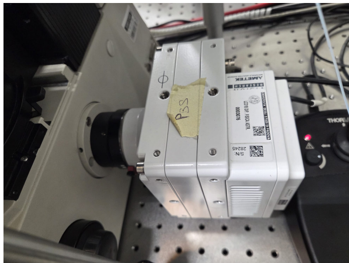
Figura 3.2: Fast camera (Phantom VEO-E310L).
