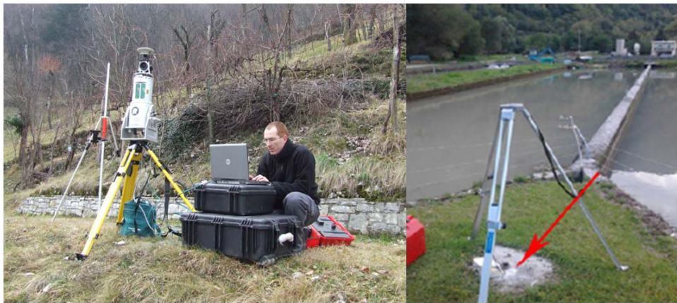
Figure 28: Esempio di strumentazione su treppiede e del posizionamento in corrispondenza del caposaldo nell'impianto di itticoltura in golenale destra del Piave
