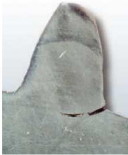
Figura 2.21: Immagine di una ruota dentata sezionata che evidenzia la propagazione di una cricca per fatica al piede del dente.
