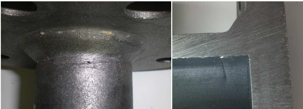
Figura A.3 - Foto del provino N°5 criccato sul tubo.
