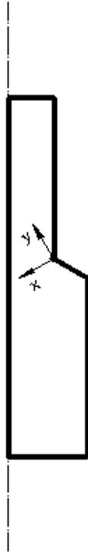
Figura 4.185: Sistema di riferimento locale adottato per una corretta analisi tramite gli NSIFs.
