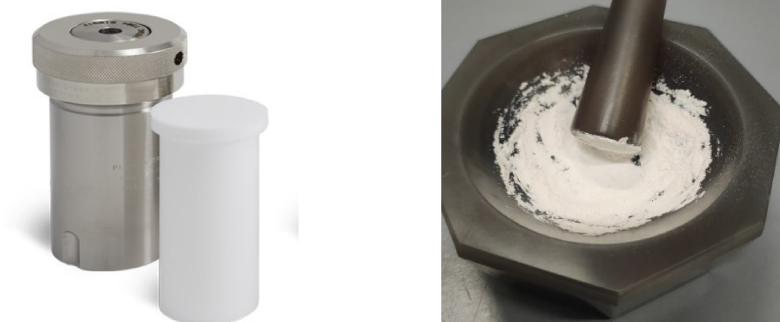
Figura 25: A sinistra è rappresentato il reattore a bomba con il liner in teflon [Parr Instrument Company], a destra la polvere di NPs di titania finemente tritata con mortaio e pestello.
