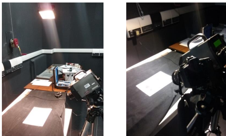
Fig.3.3 – Layout di misura: nella prima immagine, set di colori campione, spettrometro e lampada ad alogenuri; nella seconda immagine, viene posizionata la fotocamera digitale.
