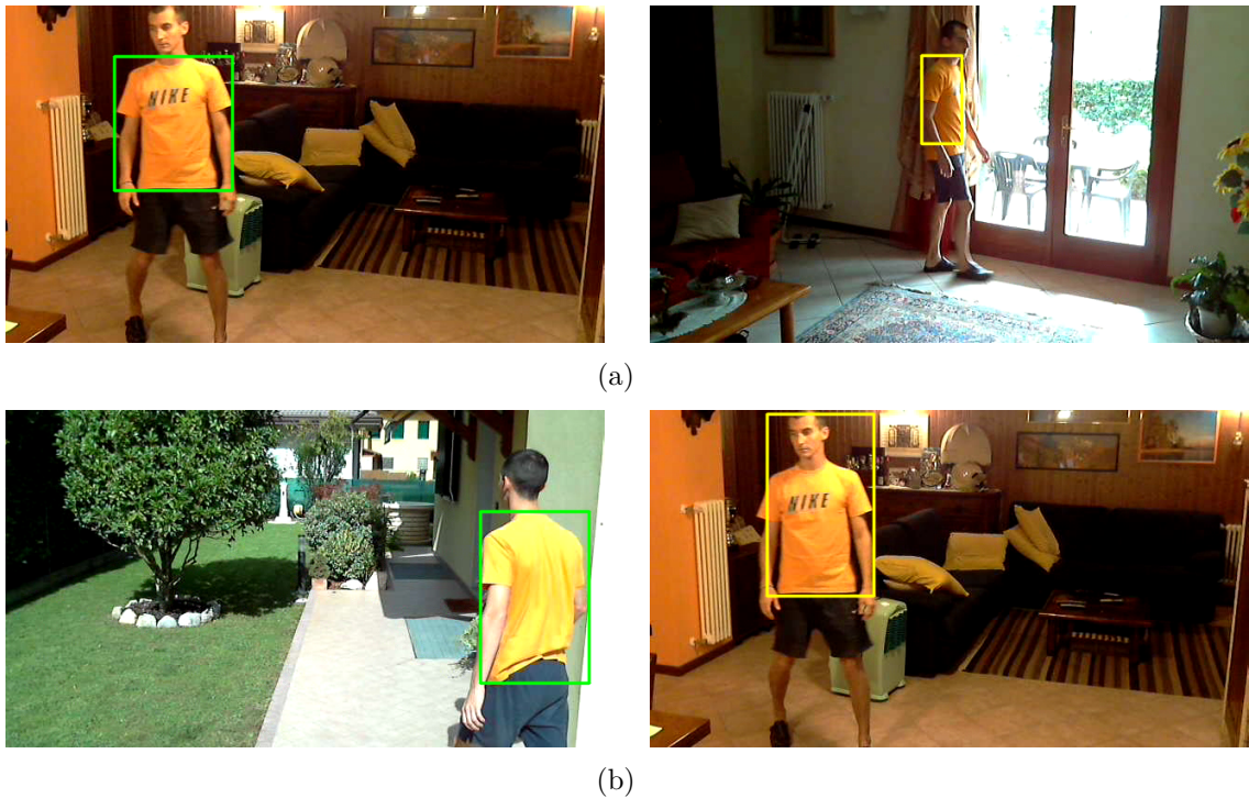
Figura 4.1. Esempio di individuazione corretta del target; sulla sinistra i frame sui quali è stato calcolato l'istogramma del target e il relativo bounding box, mentre sulla destra i frame dei video sui quali è stato ritrovato il target e il relativo bounding box
