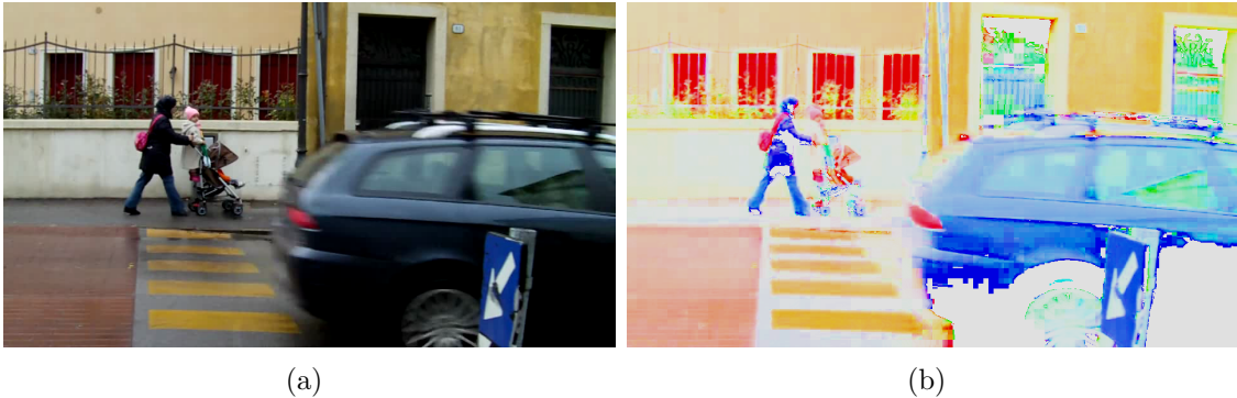
Figura 3.3. A sinistra l'immagine originale RGB; a destra quella convertita in HSB la cui componente B, per scopi puramente rappresentativi, assume il valore arbitrario 224
