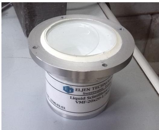
**Figura 4.3:** Contenitore con lo scintillatore liquido EJ-309.
