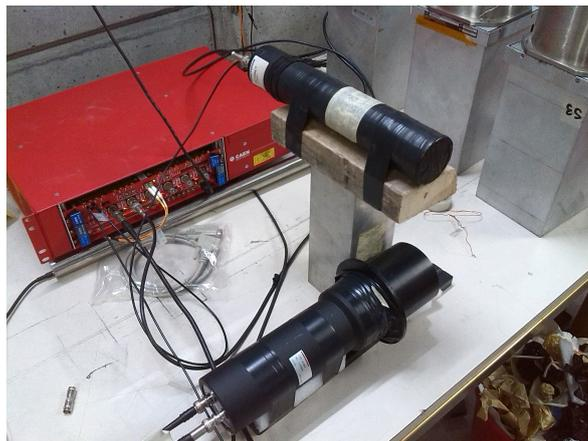
**Figura 6.12:** Apparato sperimentale allestito per la misura di 6 giorni del fondo ambiente, registrando gli eventi in coincidenza, osservati con l'EJ-228 (in alto) e il rivelatore da 3'' (in basso).
