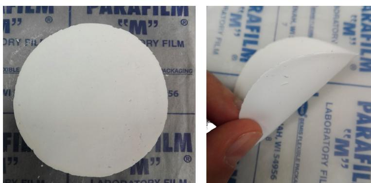
**Figura 4.4:** Disco contenente LiF e ZnS(Ag) e diametro pari a 2", prodotto presso i Laboratori Nazionali di Legnaro. A destra, si può osservare la consistenza flessibile del materiale.
