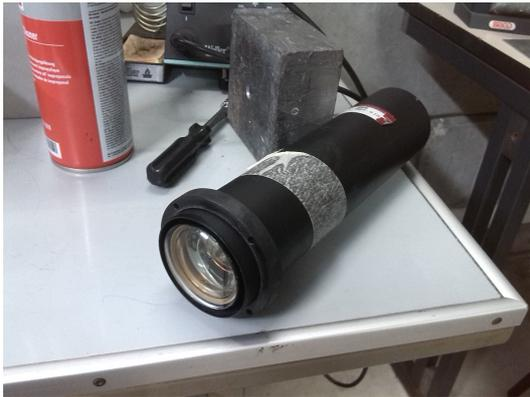
(a) PMT HAMAMATSU H1949-51, diametro 2'', dopo la fase di pulizia della superficie di ingresso.
