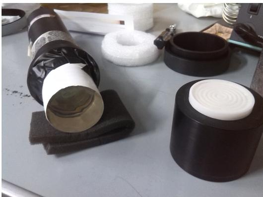
(c) EJ-299-33A (2015) avvolto con *Teflon* e unito al PMT. In parte, EJ-420, prima di essere unito alla superficie libera del plastico.
