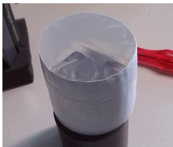
**Figura 2.20:** Deformazione di un campione di EJ-299-33A, per l'effetto combinato dell'alta temperatura all'interno del laboratorio (fino a 30-35 °C), durante il suo utilizzo, e dello stretto rivestimento con nastro adesivo applicato sul materiale.
