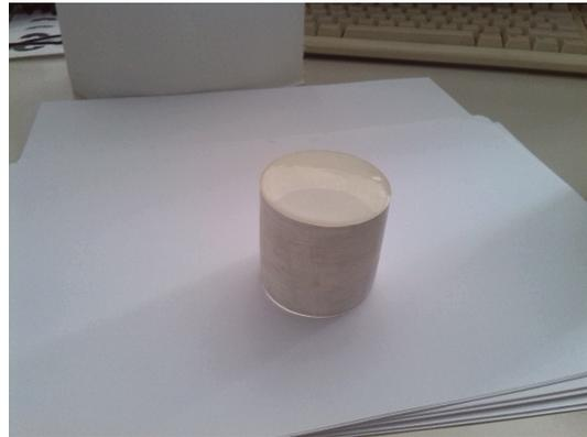
(b) Scintillatore plastico, EJ-299-33A (2015), prima dell'accoppiamento al PMT.
