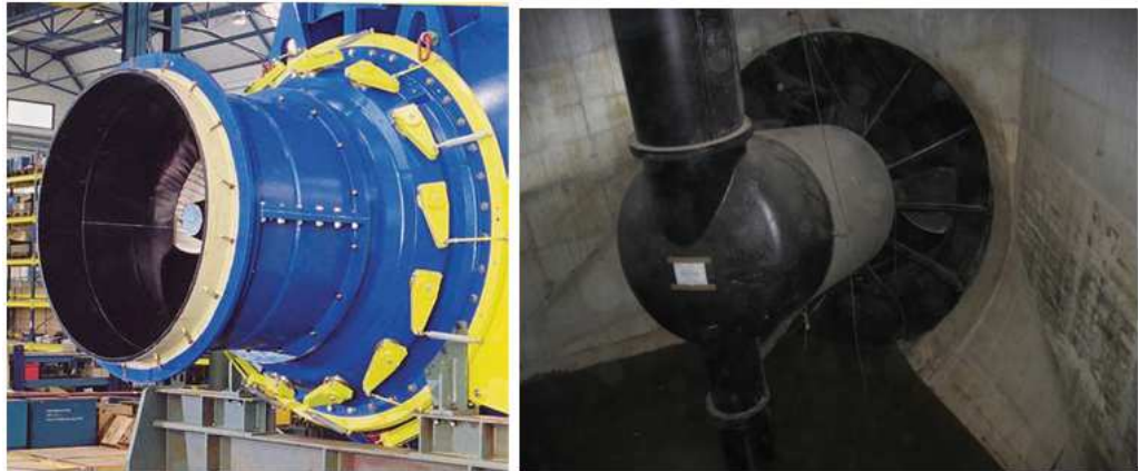
Fig.4.5: sinistra unità a doppia regolazione ECOBulb™; destra turbina a bulbo montata a Paulo
