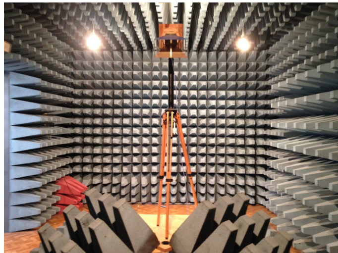
Figura 5.9: Foto del setup utilizzato per le misure di guadagno in camera anecoica; è possibile notare l'antenna ricevente posta ad un'angolazione di circa 30^\circ rispetto all'antenna in esame
