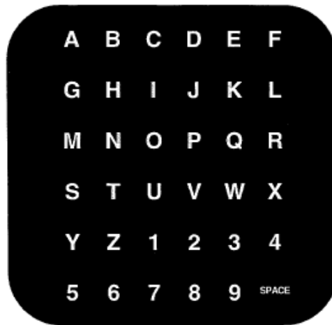
Figura 21: interfaccia utilizzata da Farweel e Donchin per la più recente versione della loro BCI
