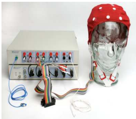
Figura 2: a sinistra un apparato per la registrazione del segnale EEG; nell'immagine a destra una camera adibita alla MEG.
