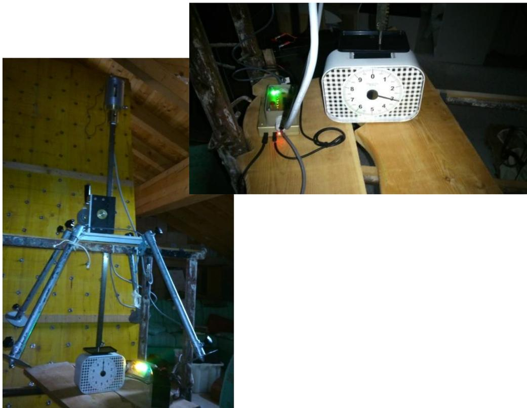
**Fotografia 8.1** Taratura della cella di carico caricando una bilancia analogica con capacità  $10kg$ .
