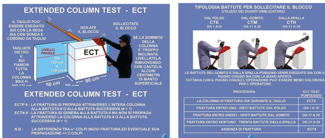
Figura 4.11 Test ECT (test di compressione della pala – test della colonna estesa) [8].
