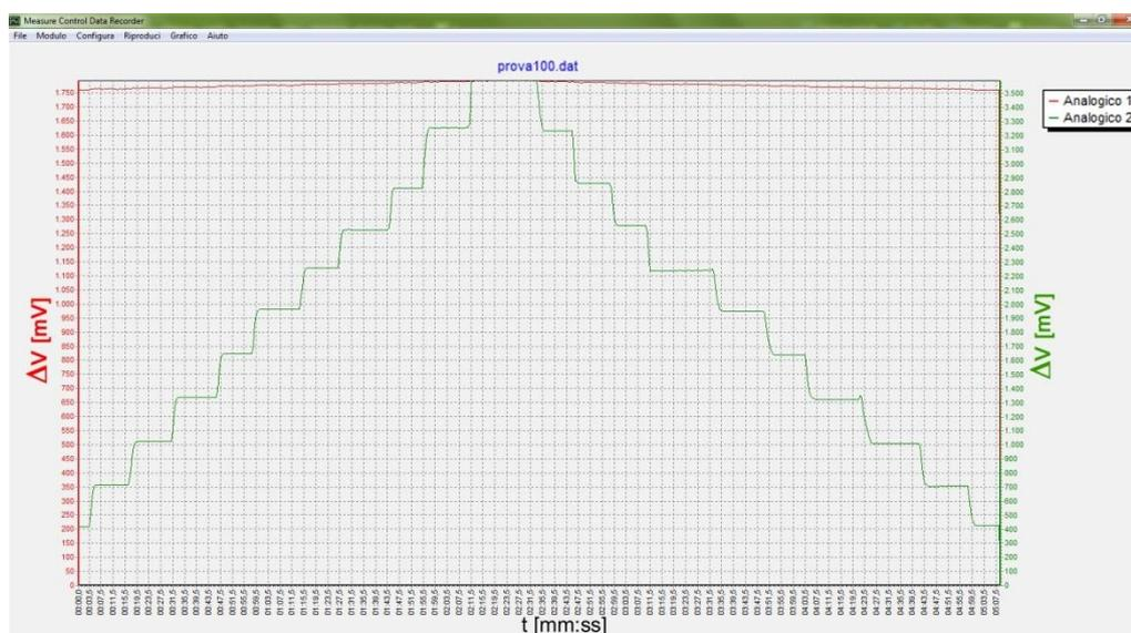
**Figura 8.1** Grafico di taratura della cella di carico: in ordinata la differenza di potenziale in mV, in ascissa il tempo in minuti e secondi (programma MeCoDaRec).
