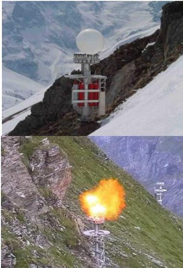
**Figura 5.9** Avalhex con pallone pronto per la detonazione ed esplosione della miscela gassosa [20].
