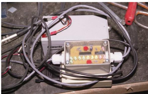
Figura 7.11 Datalogger con circuito fissato sopra con, a fianco, la batteria di alimentazione [26].
