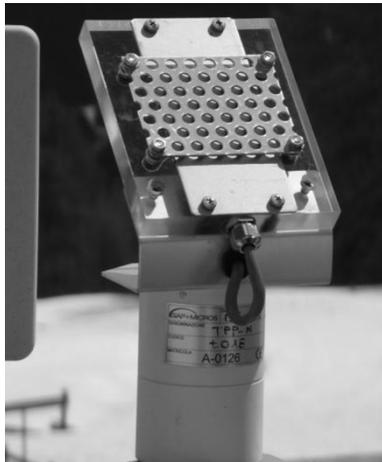
**Fotografia 4.6** Trasduttore di presenza di pioggia e neve.
