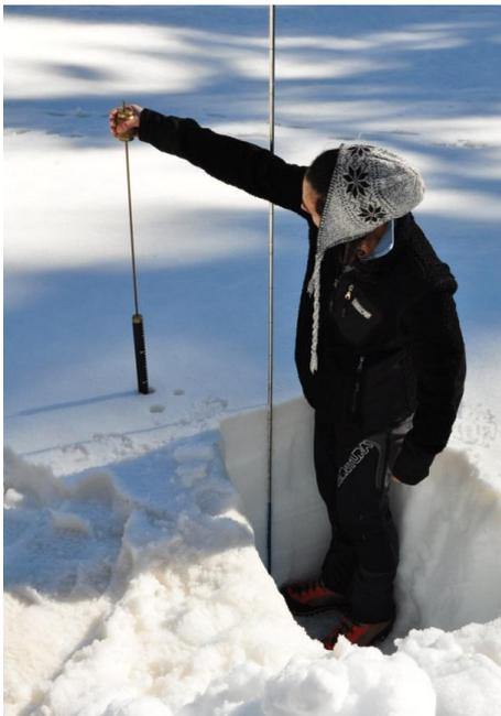
**Fotografia 4.9** Test con sonda a massa battente.
