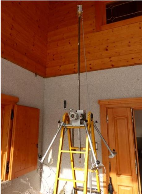
**Fotografia 8.2** Taratura potenziometro a tutta altezza dello strumento.
