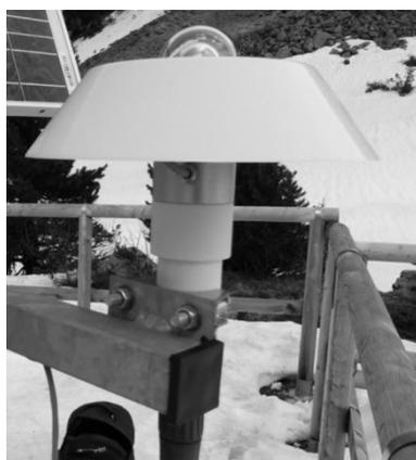
**Fotografia 4.8** Sensore della radiazione solare.
