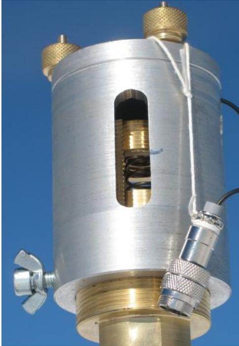
**Fotografia 8.6** Particolare del cilindro esterno con molla in posizione ottimale.
