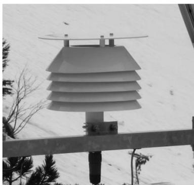
**Fotografia 4.2** Sensore temperatura dell'aria.
