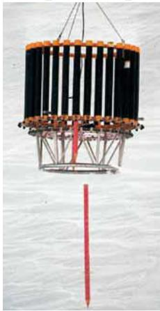
**Figura 5.7** Dispositivo trasporto e rilascio cariche esplosive [13].
