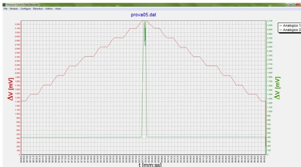
**Figura 8.3** Grafico di taratura del potenziometro: in ordinata la differenza di potenziale in  $mV$ , in ascissa il tempo in minuti e secondi (programma MeCoDaRec).
