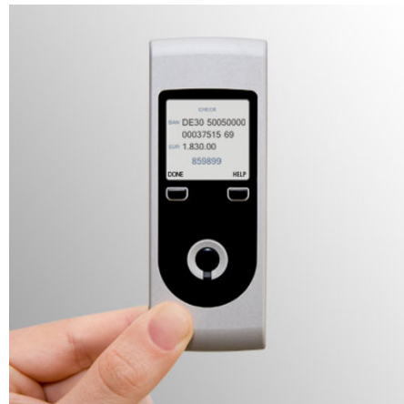
(b) Un dispositivo dedicato dotato di fotocamera per la decodifica del criptogramma
