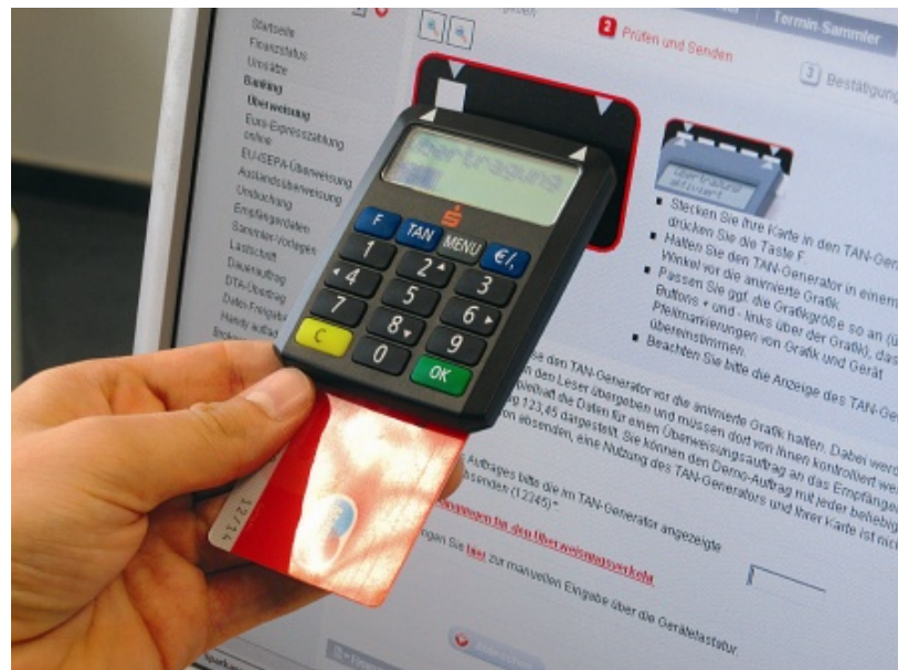
Figura 4.8: Un dispositivo ChipTAN durante la scansione dello speciale codice a barre
