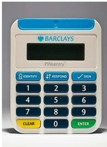
Figura 4.6: Un dispositivo CAP con una personalizzazione Barclays
