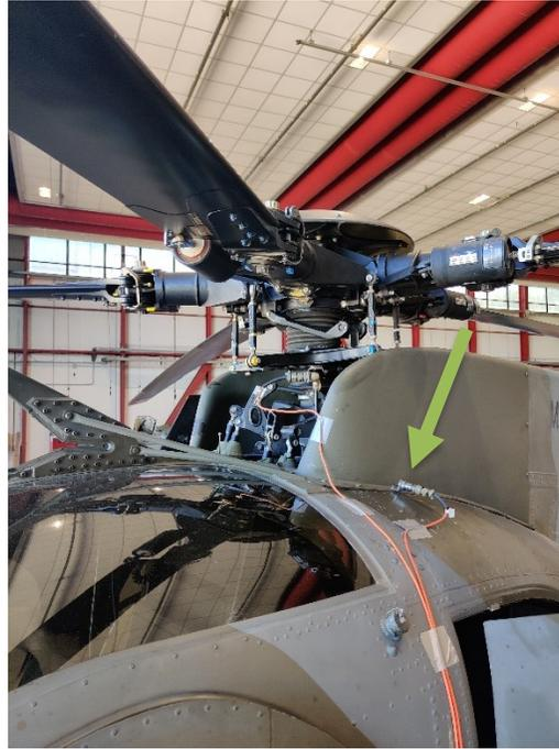
*Figura 5.5 POSIZIONAMENTO SENSORE VIBRAZIONI LATERALI*
