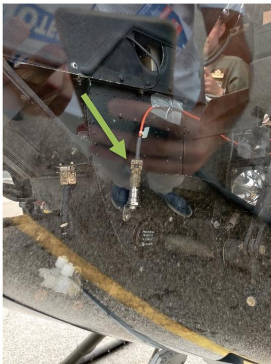
*Figura 5.6 POSIZIONAMENTO SENSORE VIBRAZIONI VERTICALI*
