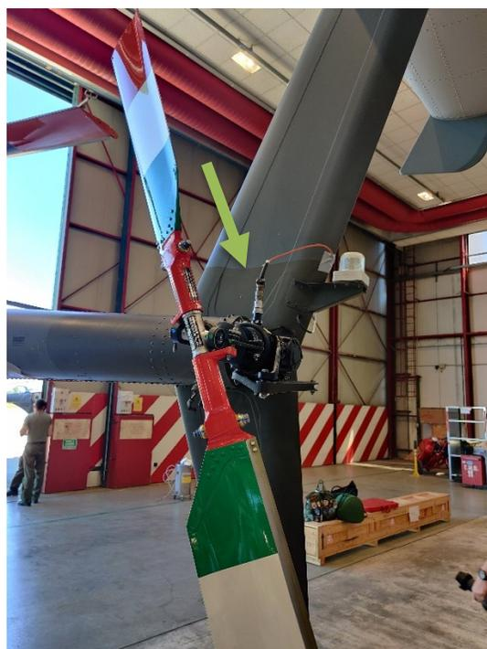
*Figura 5.7 POSIZIONAMENTO SENSORE PER LE VIBRAZIONI SULLA CODA*
