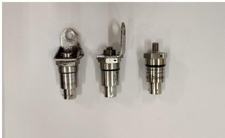
Figura 5.2 ACCELEROMETRI USATI PER I TEST
