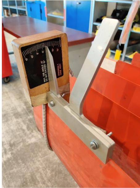
*Figura 5.11 DISPOSITIVO DI PIEGATURA DELLE ALETTE DI COMPENSAZIONE*
