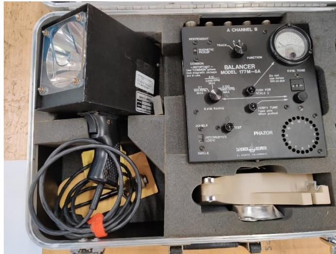
Figura 5.1 VIBREX BALANCER MODEL 177M-6A UTILIZZATA PER I TEST
