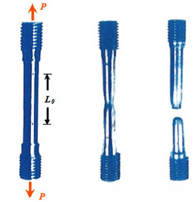
Figura 23: Esempio di strizione che interessa un provino sottoposto a trazione.
