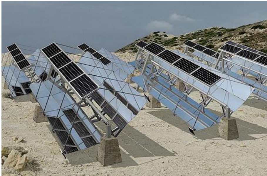
Fig. 7.2: Moltiplicatore solare con pannelli bifacciali
