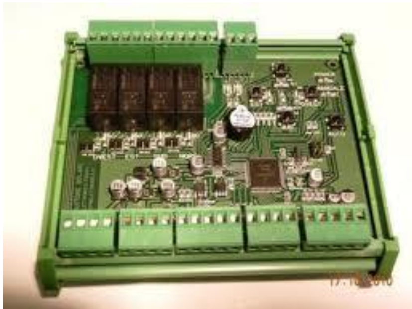
Fig. 9.5: Centralina di un inseguitore solare
