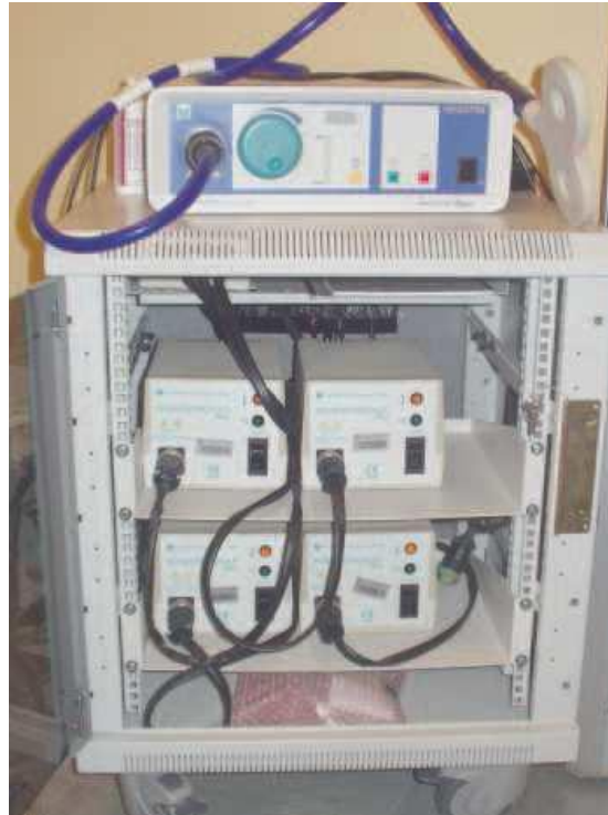
Figura 2.1: Apparecchiatura presente nel laboratorio e utilizzata per la TMS. Sono chiaramente visibili l'unità centrale (in alto) a cui è collegato il coil focale a forma di "8" e i booster situati all'interno del carrello che agiscono da condensatori. Tramite l'unità centrale è possibile selezionare il tipo e l'intensità di ogni stimolo.
