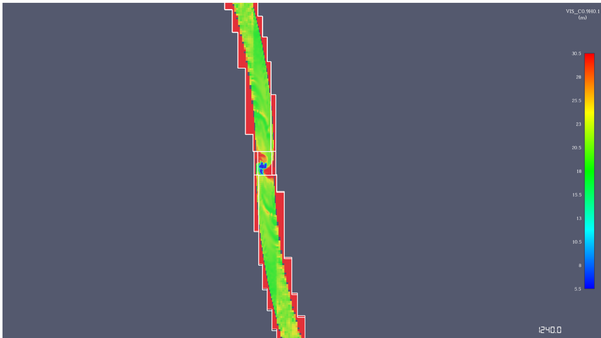
Figura 5.14: Andamento della visibilità nello scenario D.4 al termine della simulazione, a quota 2 m.
