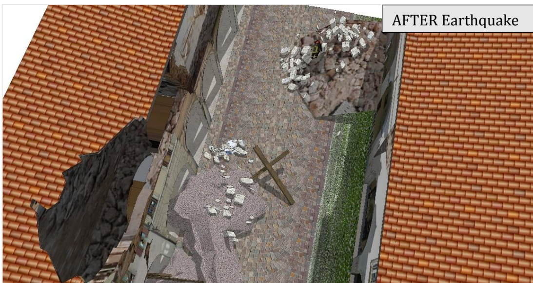
Figura 6.22 - Simulazione 3D del crollo di edifici in muratura a seguito di un evento sismico di forte intensità. Applicazione realizzata in Via XX Settembre a Conegliano. Sono presenti macerie nella strada, ma il transito è comunque possibile.
