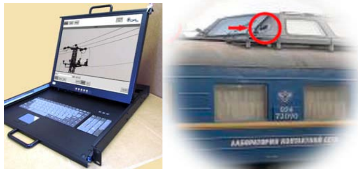
Fig 1.24 – Dispositivo di rilevazione dell'effetto corona Rail
