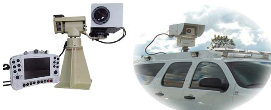
Fig 1.23 – Dispositivo di rilevazione dell'effetto corona Ranger
