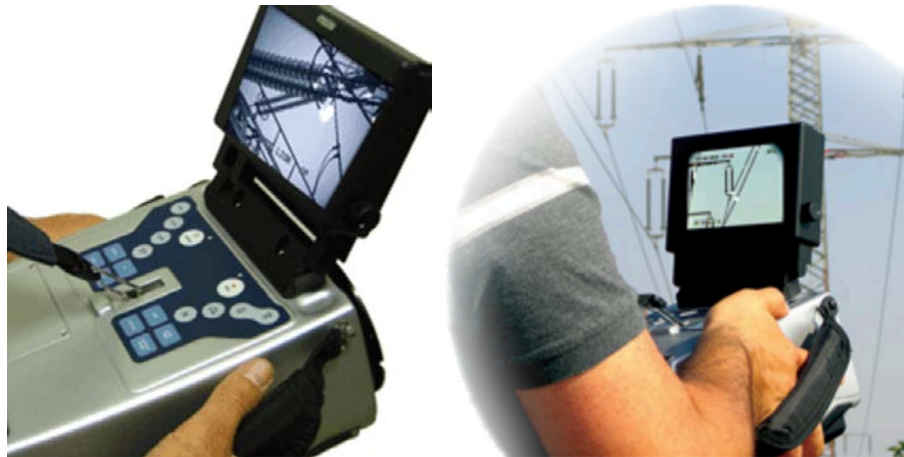
Fig 1.20 – Dispositivo di rilevazione dell'effetto corona Superb
