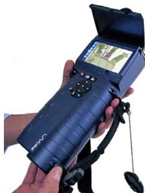
Fig 1.19 – Dispositivo di rilevazione dell'effetto corona Uvollè
