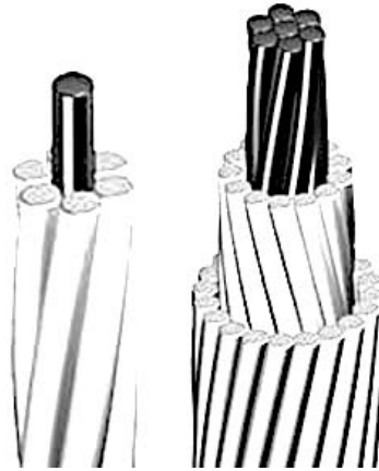
Fig 5.6b – Rappresentazione tridimensionale di un ACSR.
