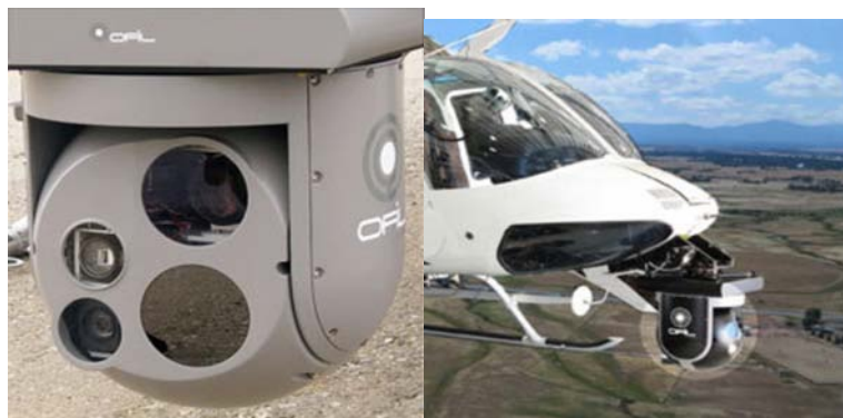
Fig 1.21 – Dispositivo di rilevazione dell'effetto corona Rom
