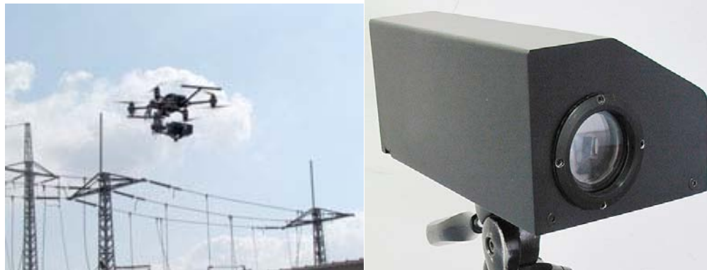
Fig 1.22 – Dispositivo di rilevazione dell'effetto corona
