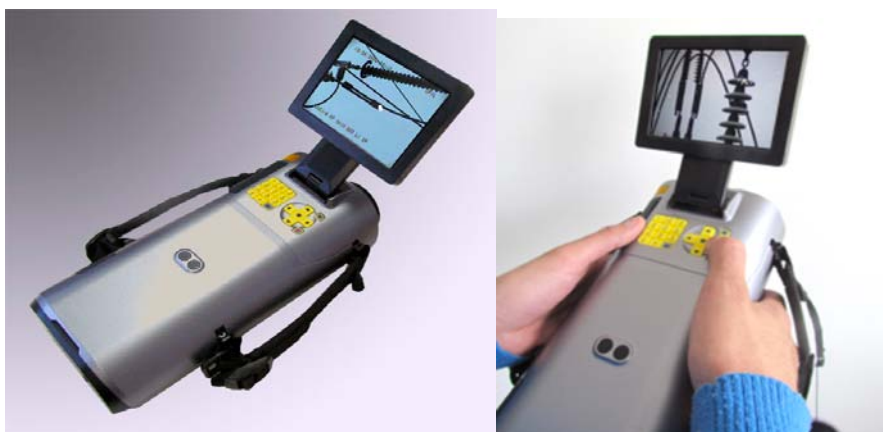
Fig 1.17 – Dispositivo di rilevazione dell'effetto corona Daycon Luminar
