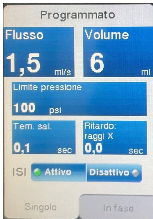
Figura 4.3b. Parametri dell'iniettore per l'acquisizione con AneurysmFlow.
