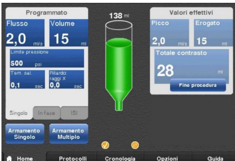
Figura 1.1.4b. Display del sistema di iniezione.
