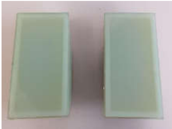
Figura 7.1. Provino in digital ABS sezionato e spianato
