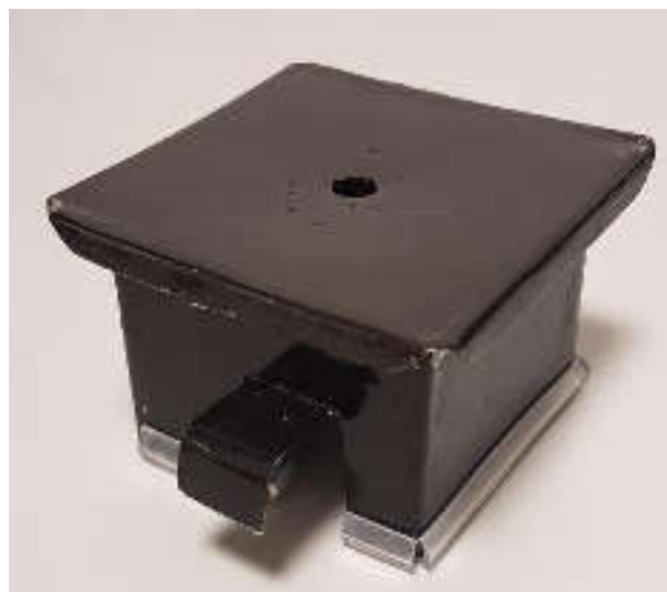
Figura 5.9. Camera di contenimento temperatura
