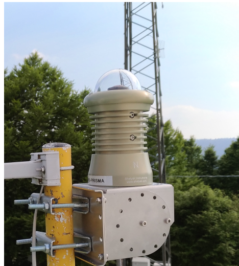
FIGURA 1.2: L'all-sky camera del Dipartimento di Fisica e Astronomia G. Galilei installata presso l'Osservatorio INAF di Cima Ekar ad Asiago, operante dal 28 maggio 2017 nella rete nazionale PRISMA.
