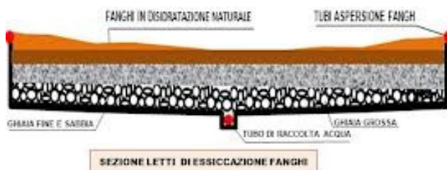
Figura 27 Letti di essiccamento dei fanghi
