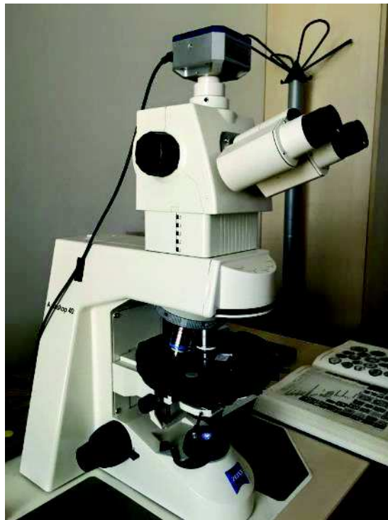
Figura 3.4: Microscopio ottico polarizzatore utilizzato per l'analisi dei campioni
