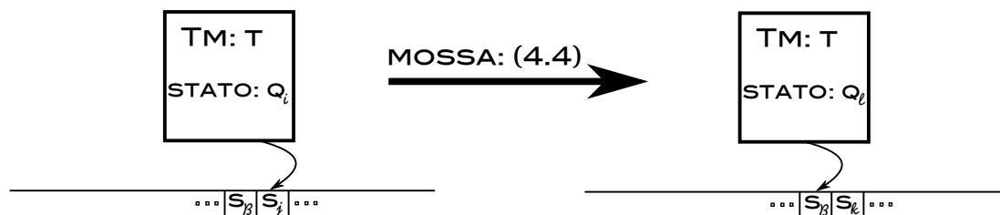
Figura 3.3: La macchina di Turing T che compie la mossa \delta(q_i, s_j) \rightarrow (q_l, s_k, L) “in mezzo” al nastro.
