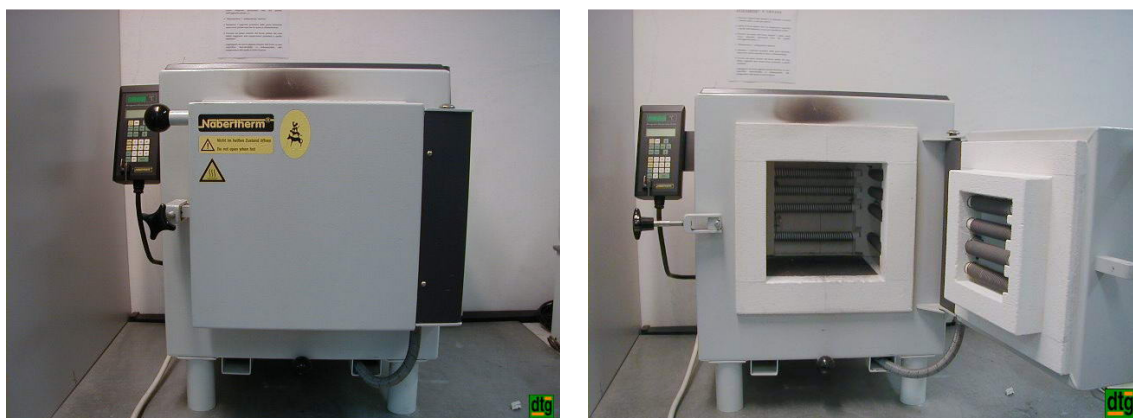
Figura 4.34 Forno utilizzato per il trattamento di solubilizzazione
