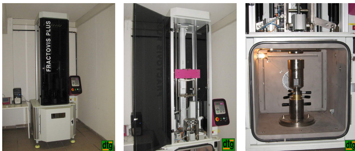
Figura 4.22 Macchina per prove di resilienza CEAST Fractovis plus.
