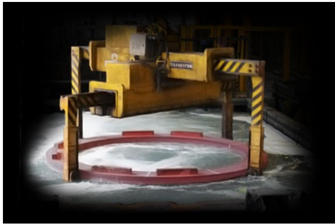
Figura 4.4 Particolare del processo di raffreddamento in acqua.
