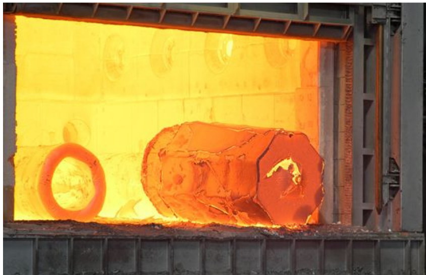
Figura 3.7 Particolare di un forno utilizzato per il trattamento di solubilizzazione
