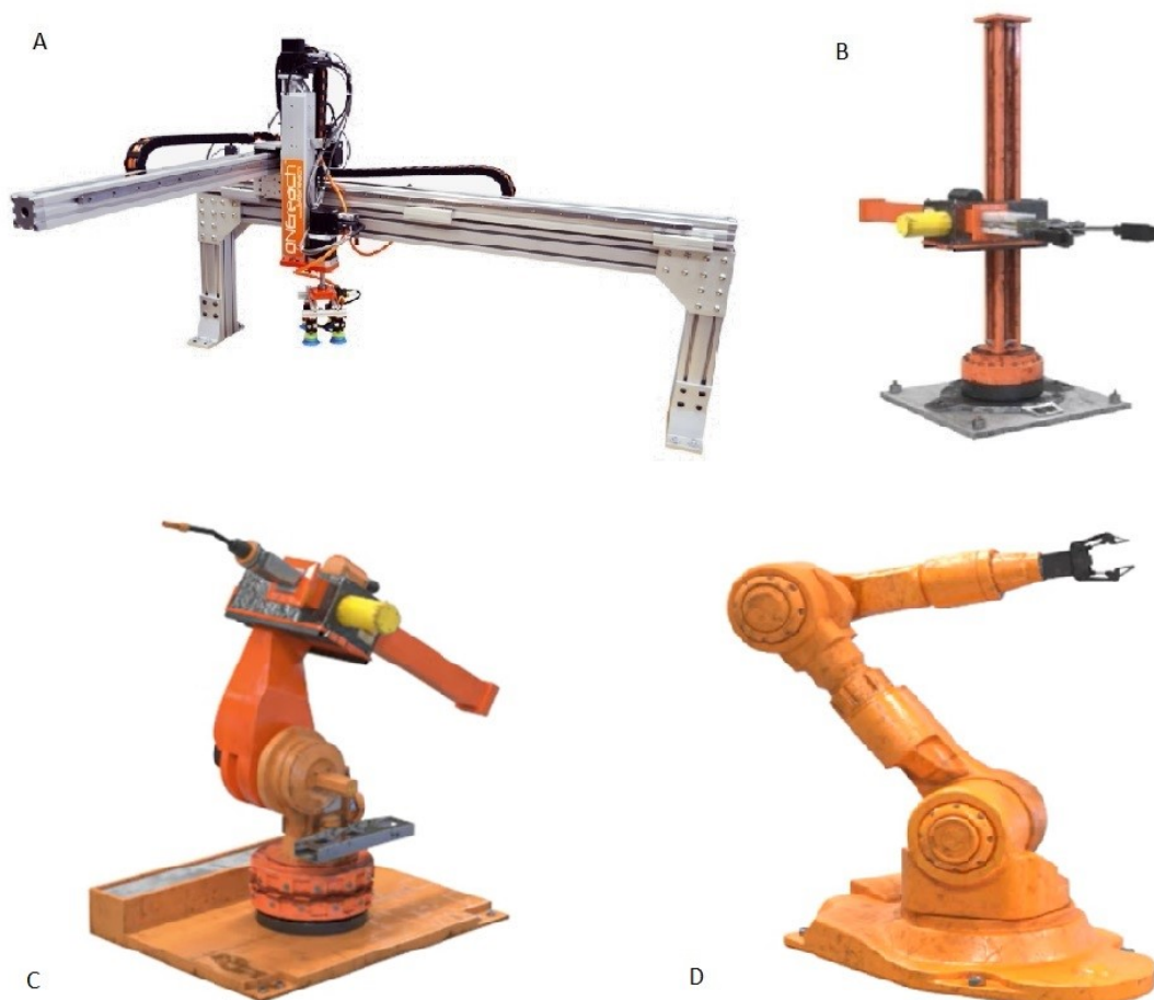
Figura 7 - Esempari delle quattro tipologie di robot: A) robot cartesiano; B) robot cilindrico; C) robot sferico; D) robot articolato.
