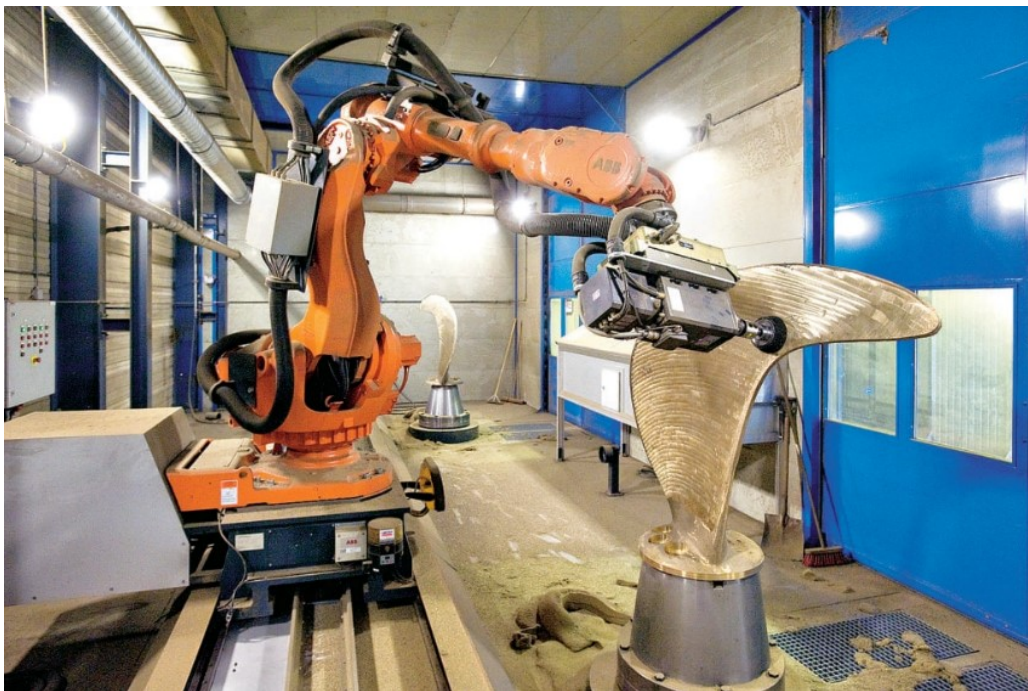
Figura 24 - Lucidatura tramite robot in un ambiente di lavoro confinato
