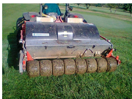
Figure 2.17, 2.18, 2.19 e 2.20: traseminatrice trainata dal New Holland (a sinistra); traseminatrice in uso (a destra e in alto a sinistra); chiodi della traseminatrice (in alto a destra).
