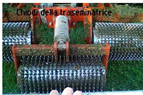
Figure 2.17, 2.18, 2.19 e 2.20: traseminatrice trainata dal New Holland (a sinistra); traseminatrice in uso (a destra e in alto a sinistra); chiodi della traseminatrice (in alto a destra).
