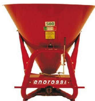
Figure 2.13 e 2.14: spandiconcime ad azione centrifuga (fig. 2.13, a sinistra) e spandiconcime ad azione gravitazionale (fig. 2.14, a destra).
