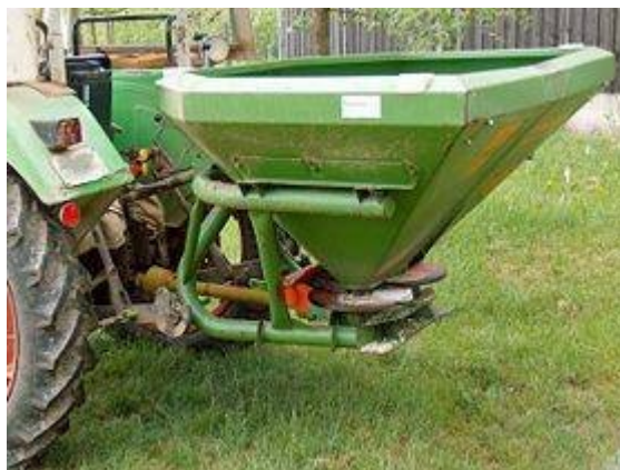
Figure 2.13 e 2.14: spandiconcime ad azione centrifuga (fig. 2.13, a sinistra) e spandiconcime ad azione gravitazionale (fig. 2.14, a destra).
