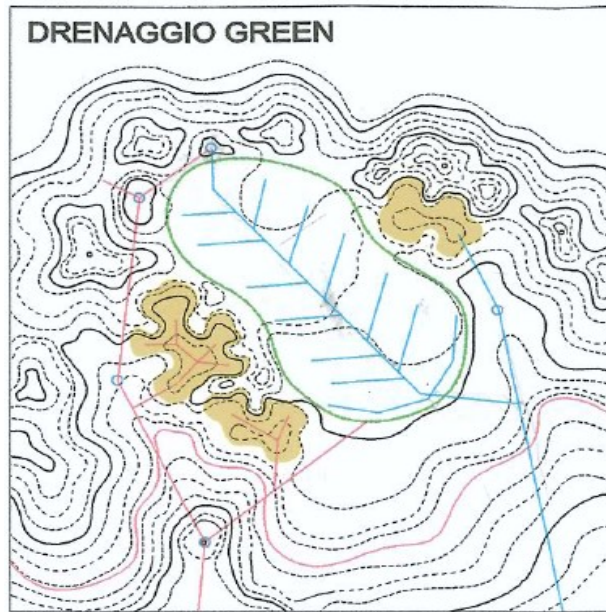
Figura 4.20: schema di drenaggio dei greens
