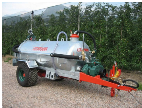
Figure 2.15 e 2.16: una normale botte per i concimi liquidi ultimo modello (fig. 16, a sinistra) e macchina utilizzata in azienda per distribuire sia i concimi liquidi, che i diserbanti.
