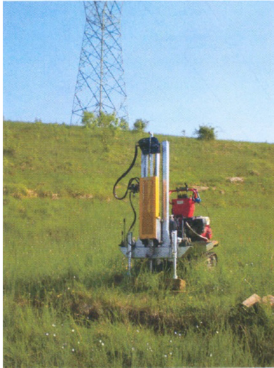
Figura 11: Macchina utilizzata per l'esecuzione delle prove penetrometriche DPSH (Fonte: Massagrande, 2012).
