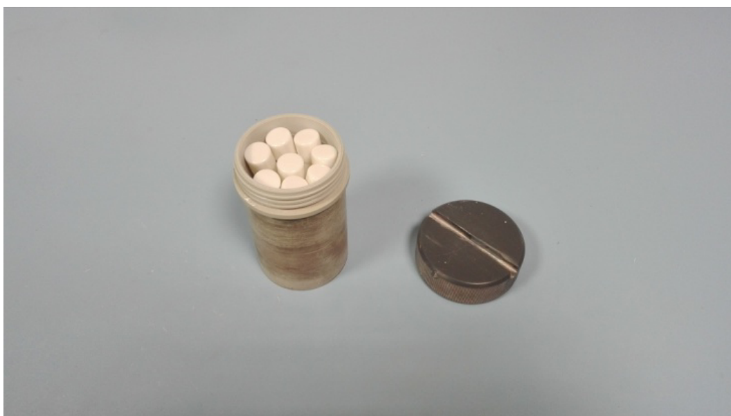
Figura 21: Giara con all'interno cilindretti in zirconio.
