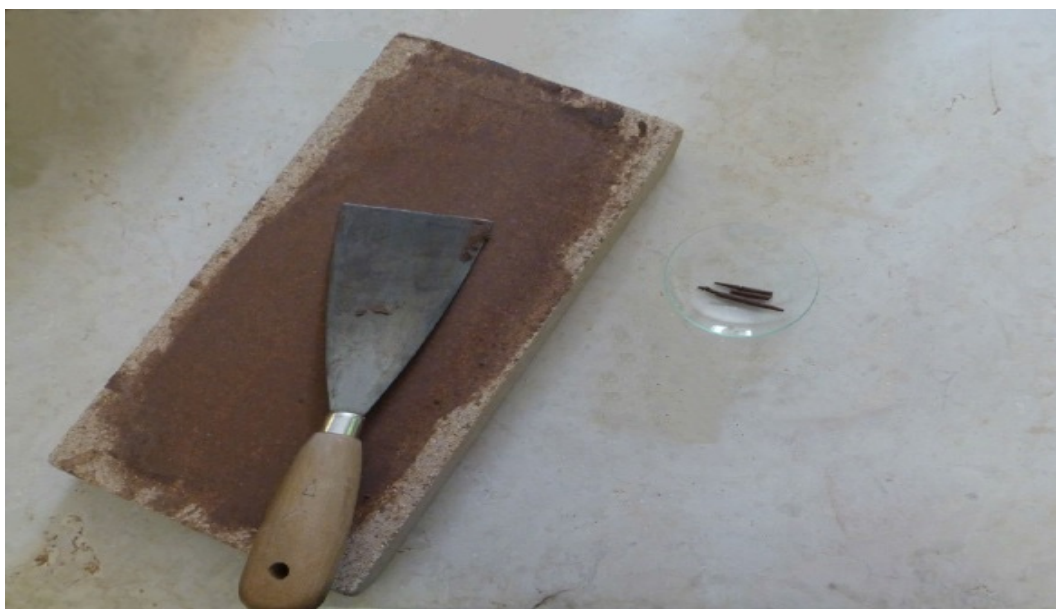
Figura 19: Pietra porosa e spatola (a sinistra) utilizzati per la creazione di piccoli cilindri di terreno (a destra) per la determinazione del limite plastico.
