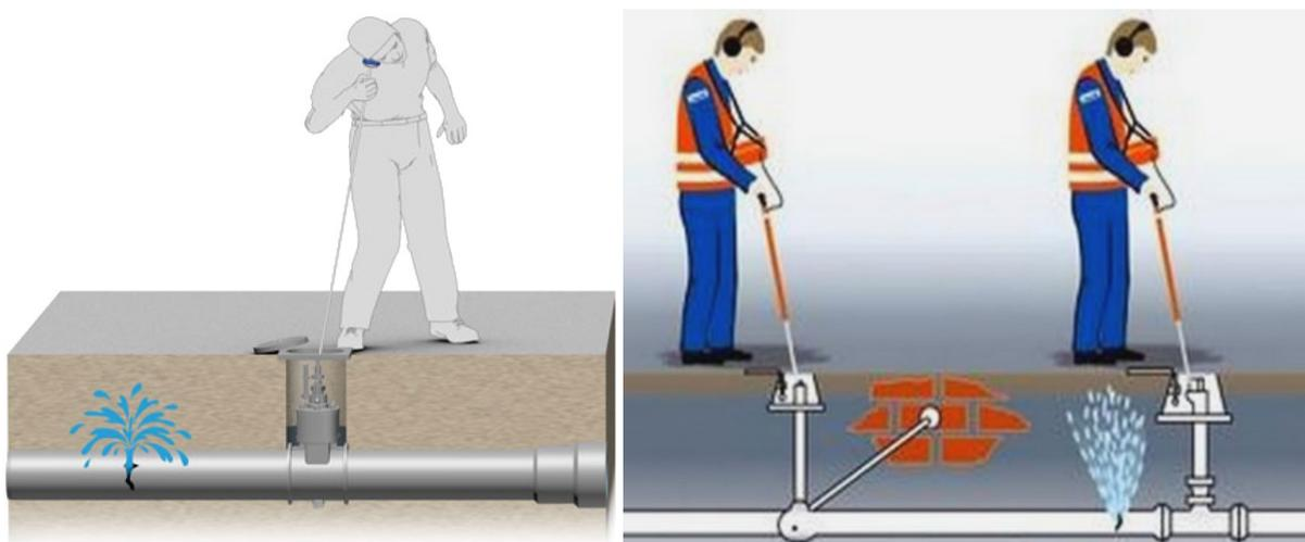
Figura 17: A sinistra l'asta geofonica di tipo meccanica; a destra quella elettroacustica.
