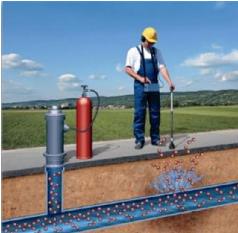
Figura 22: Ricerca della perdita idrica con il gas tracciante.
