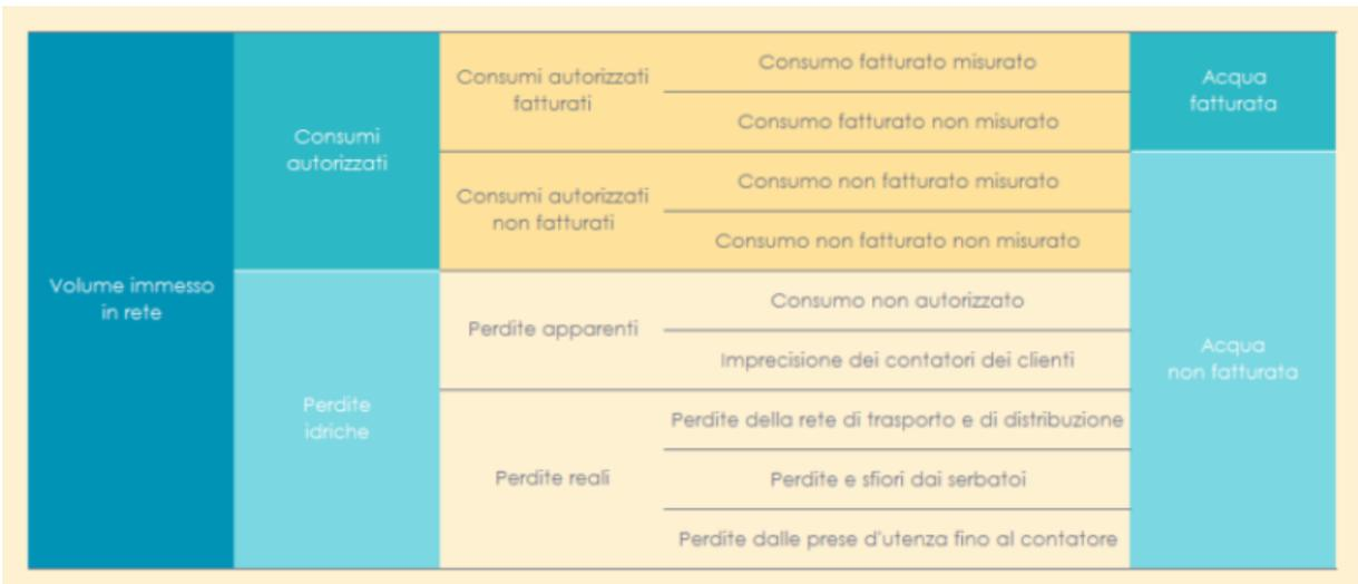
Figura 12: Schema IWA per la valutazione delle perdite idriche.
