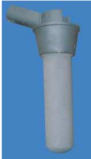
Figura 3.1 Tubo di dosaggio utilizzato nella pressofusione dell'alluminio realizzato in composito O'Sialon e carburo di silicio
