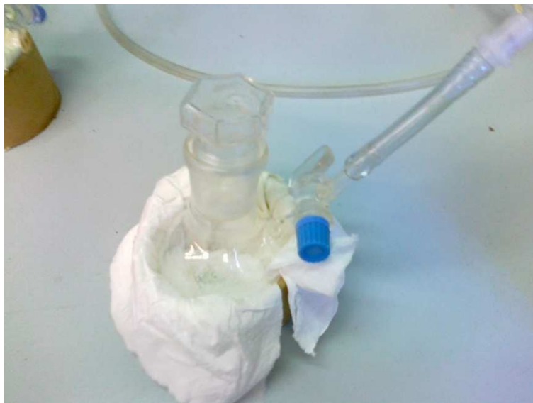
Figura 3.4 Palloncino contenente le polveri collegato ad un flusso di argon. È importante che il tappo non venga chiuso totalmente per permettere una fuoriuscita al gas immesso
