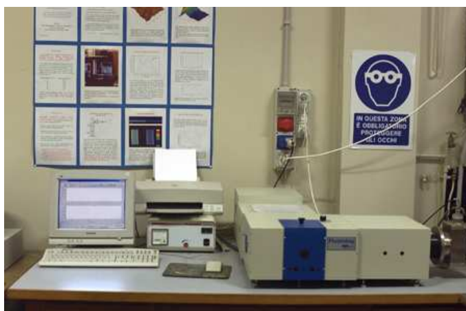
Figura 3.15 Spettrofluorimetro utilizzato per le misure di emissione dei fosfori
