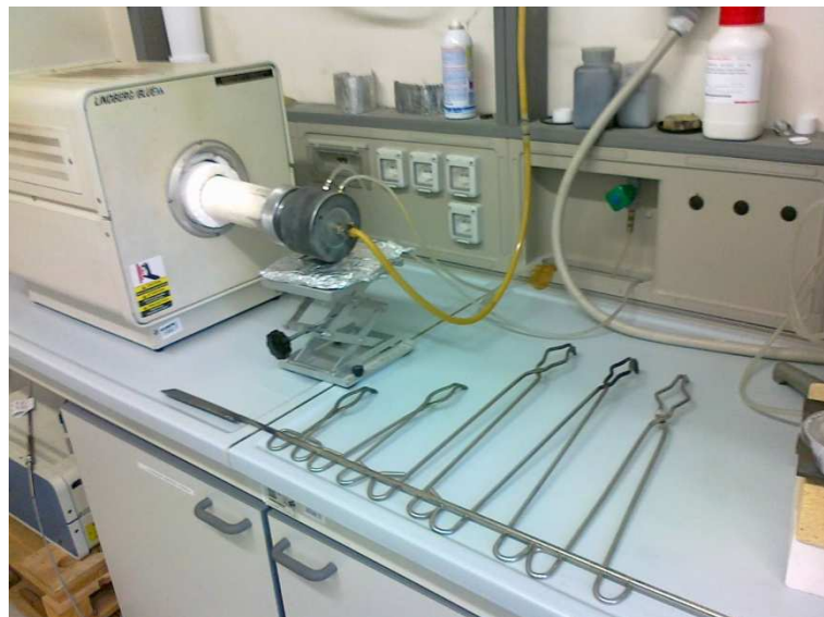
Figura 3.2 Il forno a tubo utilizzato per i trattamenti termici. Lo strumento è dotato di due teste in alluminio raffreddate ad acqua.
