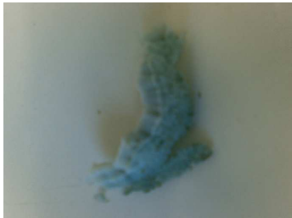
Figura 4.5 Schiuma di nanowires di Si 3 N 4 estratta dal forno dopo il trattamento termico dei campioni contenenti resina fenolica
