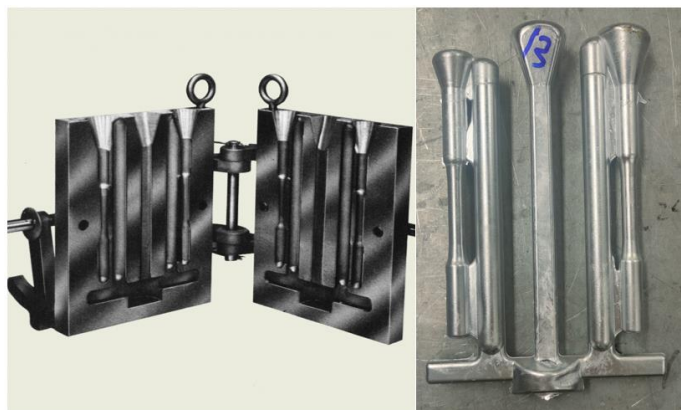
Figura 3: Stampo modello Sthal utilizzato per la creazione dei provini meccanici ed esempio di componente colato.
