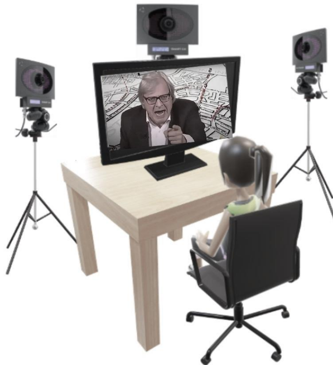
Figura 10. Il setting sperimentale prevede un sistema optoelettronico composto da 6 telecamere all'infrarosso in grado di rilevare i movimenti dei marker passivi riflettenti l'infrarosso. Il partecipante è seduto su una sedia e guarda il monitor rappresentante il video ad alto contenuto emotivo.
